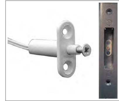
RIEGELSCHALTKONTAKT Im Schliessblech eingebaut. Wird durch den Riegel im Schloss betätigt. Rückmeldung: Tür manuel oder mechanisch abgeschlossen!
