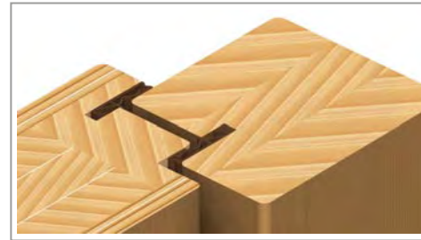
Detail - zwei Dichtungsebenen
