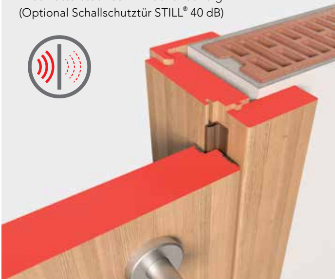
EI 60 Pfostenstock überfält (Optional Schallschutztür STILL® 42 dB)
