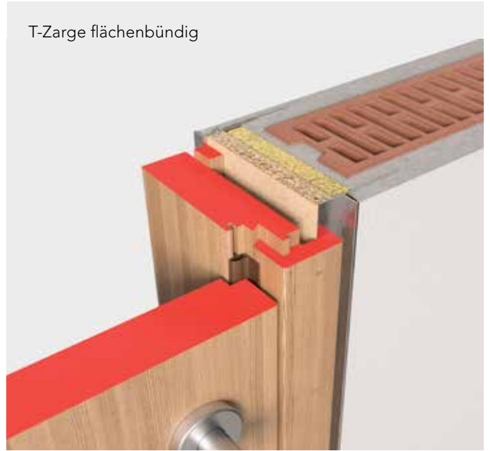
Pfostenstock flächenbündig (Optional Schallschutztür STILL® 38/40 dB)
