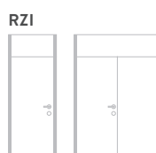
Raumhohe Zarge ohne Querteil und ohne Kämpfer, mit Oberblende bis Raumlichte von 2.600 mm (einflügelig, zweiflügelig)
