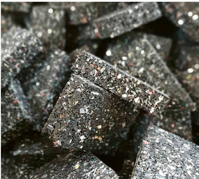
Isopads aus 95 % Altreifengranulat
