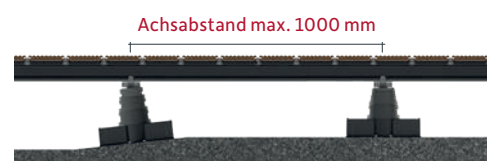
VARIO FIX mit Konstruktionsbalken 80 x 60 mm
