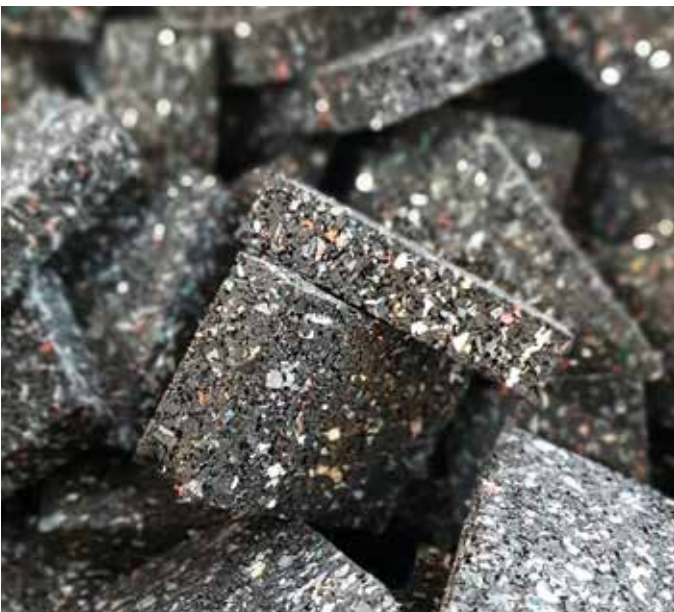
Isopads aus 95 % Altreifengranulat
